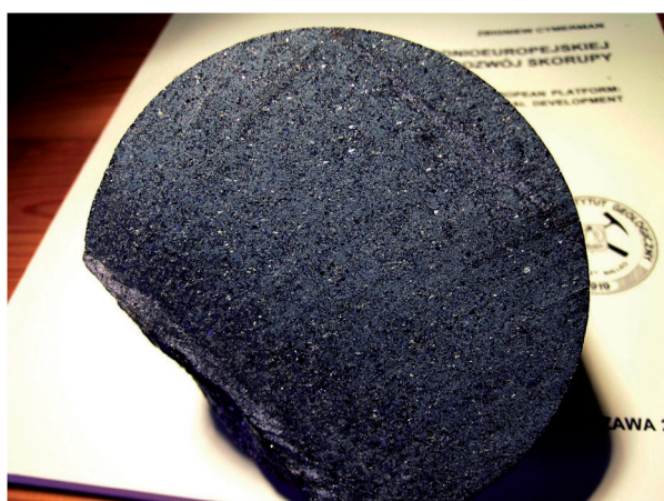
Ryc. 2. Dwa fragmenty rdzeni wydobyte z głębokich otworów wiertniczych wykonanych w rejonie Moniek reprezentujące paleoproterozoiczne lawy i tufy (wulkanizm łuku wysp i strefy subdukcji) zmienione przez pogrążenie i podgrzanie (zmetamorfizowane).
