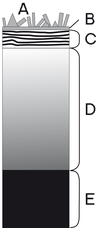
Ryc. 1. Model budowy kutykuli (wg JEFFREEGO 1996, zmieniona).
